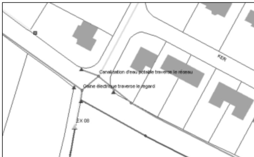
**CONSTAT** : Une canalisation d'adduction en eau potable passe dans le réseau d'eau pluviale.
