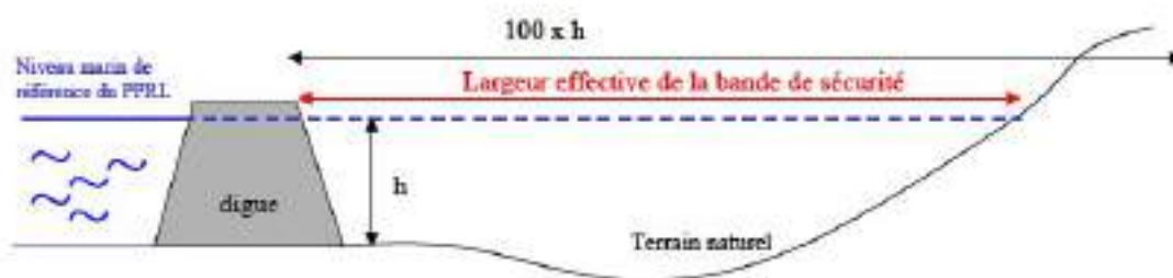
Figure 32 : schéma précisant la définition de la bande de précaution (source : guide méthodologique du PPRLN29)
