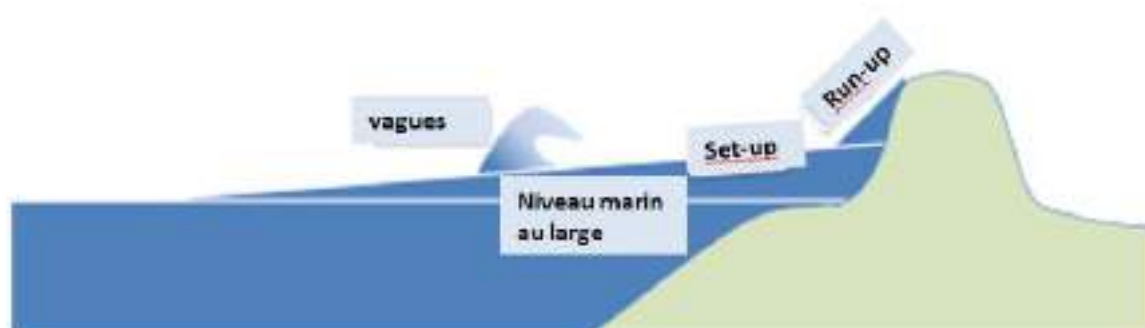
Figure 23 : principe du run-up
