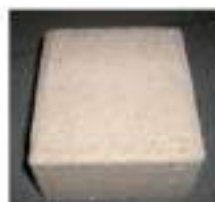
Pavés en béton poreux
