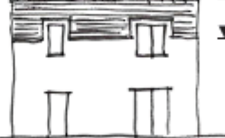
Nouvelle construction hauteurs NON adaptées La façade est trop haute, la toiture pas assez présente
